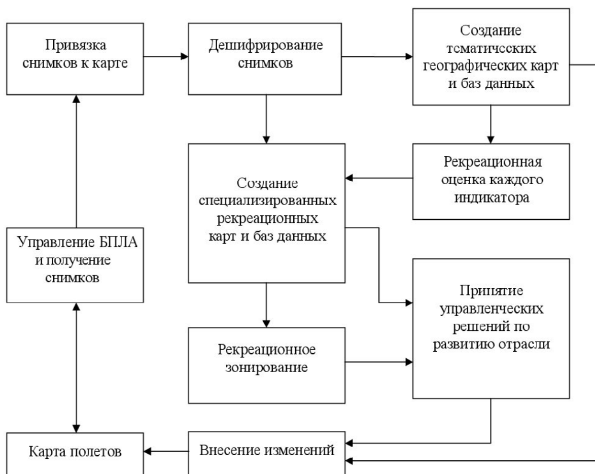
Рис. 1. Общая схема использования ГИС-технологий и беспилотных летательных аппаратов (БПЛА) в рекреационных целях
